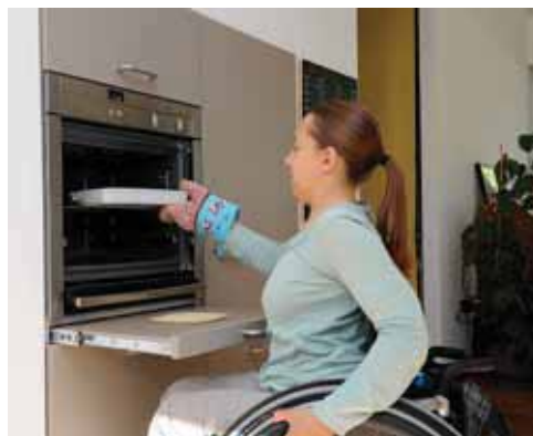
81 Die Ablage dient auch als Schutz vor Verbrennungen.
